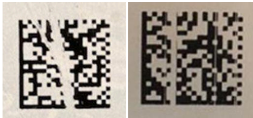
Нарушение целостности КМ*
