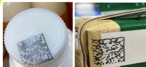
Смещение кода маркировки при печати
