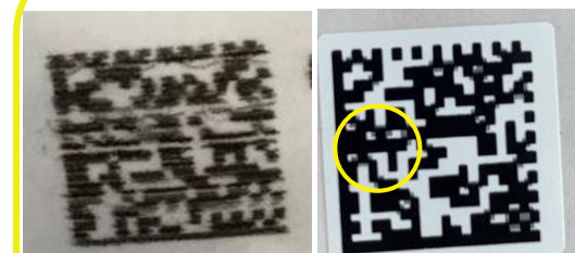
Смазывание кода маркировки или его отдельных элементов
